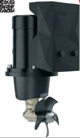
**Bow Propeller Quick BTQ140** Elica di prua Bow Thruster Quick BTQ140. - Elica singola in robusto materiale composito- Riduttore in bronzo- Carter di protezione per i teleinvertitori in robusto materiale composito- Anodo di zinco di serie indipendente dal riduttore e facilmente sostituibile- Dotata di giunto elastico parastrappi- Lunghezza imbarcazione consigliata 6-10 m (20-33 ft)
